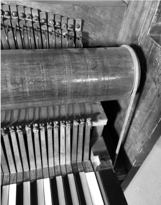
Abb. 4: Detailfoto des Orpheon im Deutschen Museum: Zylinder, dahinterliegende Klangstäbe, darunter Winkelmechanik mit Zugdraht, Lederriemen zum Schwungrad (Foto: Christian Rust).
