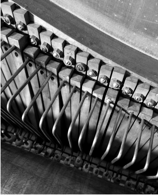
Abb. 3: Detailfoto des Orpheon im Deutschen Museum: an Hebeln befestigte Klangstäbe mit Ledergarnierungen, hinter dem Zylinder, Blick von oben (Foto: Christian Rust).
